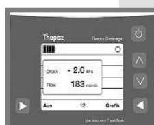
3. In Standby Modus wechseln: Taste «Aus» min. 3 Sek. drücken
